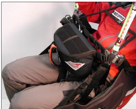
Beim Zip F und Slider F mit angebauten Frontcontainer wird der Container vom Y-belt in Position gehalten.
