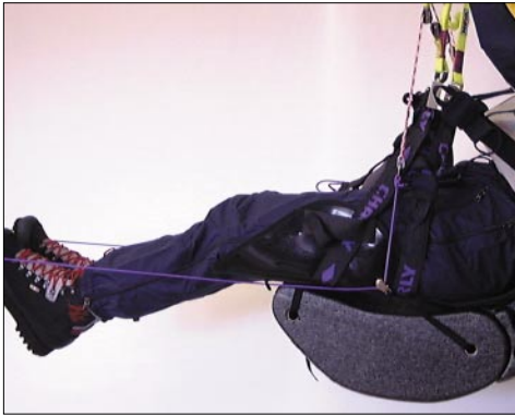
Verlauf des Beschleunigerseils (Abbildung Index ohne Rückenteil)
