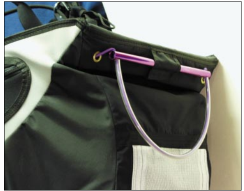
Befestigung des Beschleunigerseils während des Starts.
