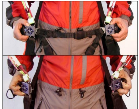
Anbringen der Gleitschirmstecker an den Tragegurten
