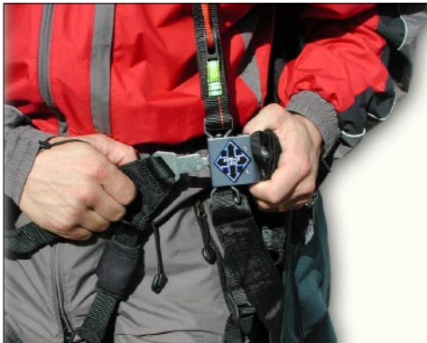
Anbringen der Gleitschirmstecker an den Tragegurten
