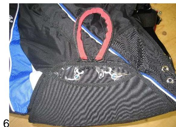
Charly-verwendet einen Loopspanner, dadurch brauchen die Splinte nicht mit einem Sicherungsfaden gesichert werden!
