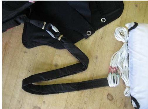
Verbindung mittels Verbindungsglied
