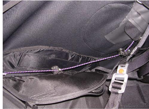
Der Beschleuniger wird vom vorderen Ende des Sitzbretts an montiert. Die Leine des Beschleunigers wird durch die seitlichen Umlenkrollen am Sitzbrett und dann durch die Rollen in der Nähe der Hüftverstellung, weiter durch die lederverstärkten Öffnungen im Neopren geführt.
