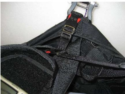
Das Cockpit lässt sich beidseitig mit zwei Schnallen befestigen. Eine Schnalle direkt unter dem Karabiner und mit der oberen Schnalle lässt sich das Cockpit mit den Schultergurten verbinden. Mit der Verbindung zu den Schultergurten wird der Winkel eingestellt. Was vor allem beim Fliegen mit Ballast sehr wichtig ist.
