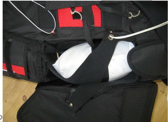
2 hinteren „Lappen“ wie abgebildet mit dem vorderen Loop verbinden
