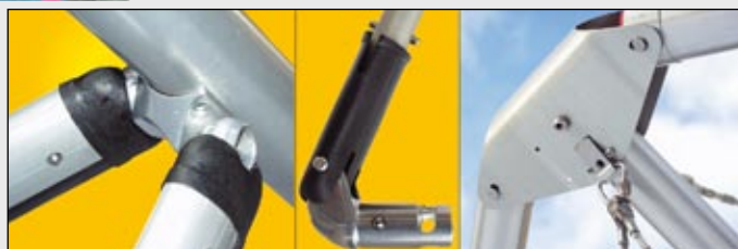
Fex-Details von links nach rechts: Trapezbefestigung mit High-Tec-Beschlägen, aerodynamisch geformte Trapezecken und Perunal-Nasenplatte.
